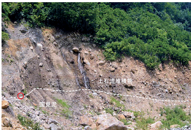
写真8 国見泥に貼り付いた土石流堆積物（刈込み池対岸）、○：試料採取位置
