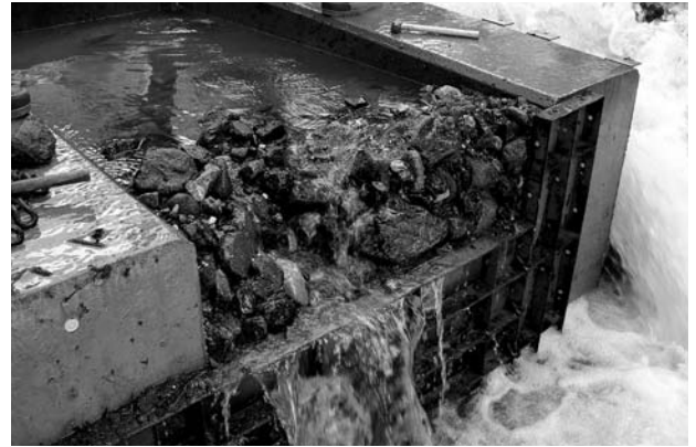
写真14 ハイドロフォン検証用の流砂計測ピットの砂礫の堆積状況（右岸下流より撮影）
