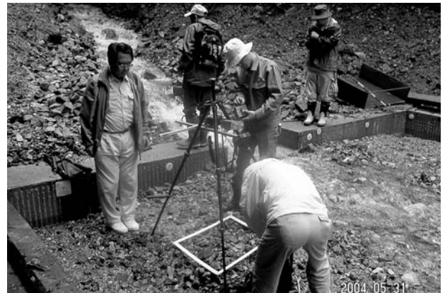
写真2 デジタルカメラによる河床の撮影の様子
