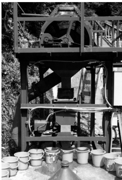
写真-22 自動流砂計測装置の採集・計測部
