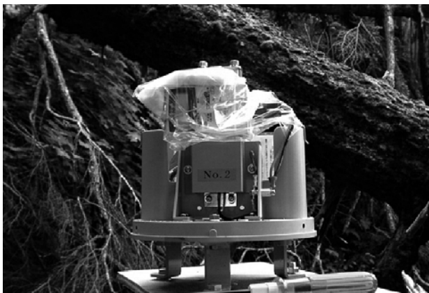
写真-4 データロガー式雨量計の内部と外観
