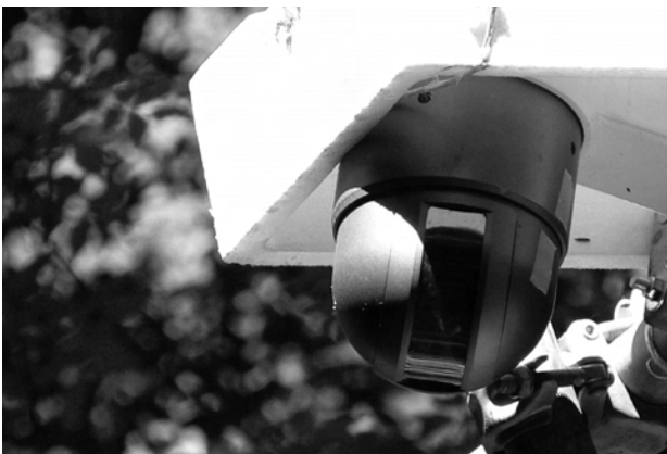
写真-15 裸地斜面のモニタリングカメラ
