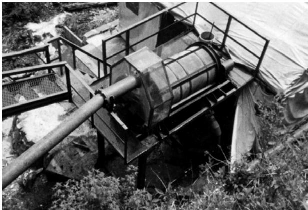
写真-21 自動流砂計測装置の水と土砂の分離部
