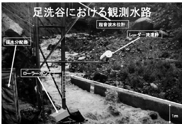
写真-34 足洗谷観測水路と観測機器
