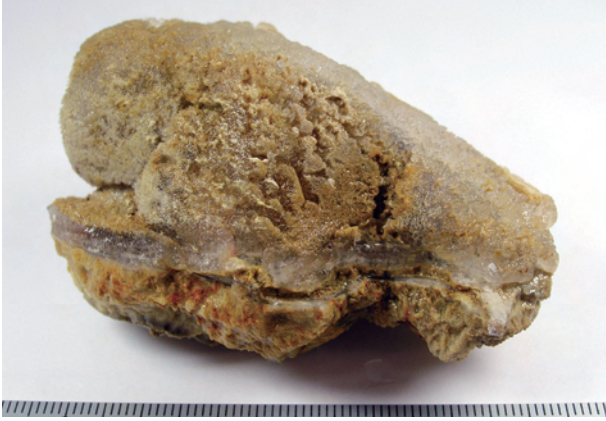
図11. 針状オパールが観察されたレキ。針状なのは片側の表面のみ。
