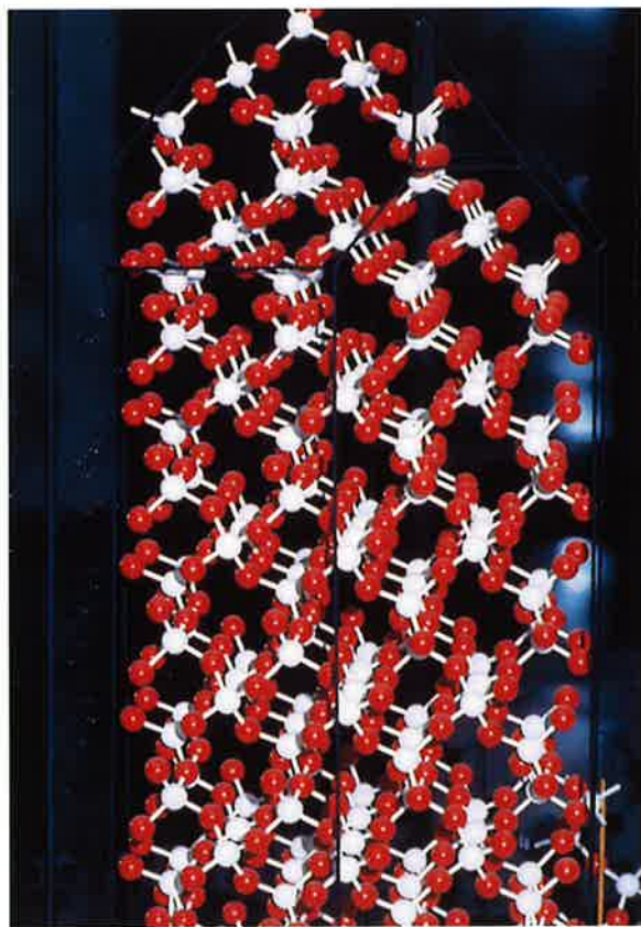
図2 石英 (水晶) の結晶構造。白丸が珪素、赤丸が酸素。SiO 4 の四面体が、頂点の酸素を共有して三次元的に連結して、このような規則正しい骨組みができる。原子が一定間隔で並んでいること (周期性)、間隔は見る方向によって違うこと (異方性) に注意。周期性と異方性が結晶の基本的な性質である。
